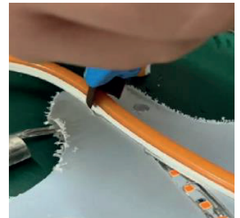
4.-Encajar el tubo de silicona. Cortar el tubo correctamente
